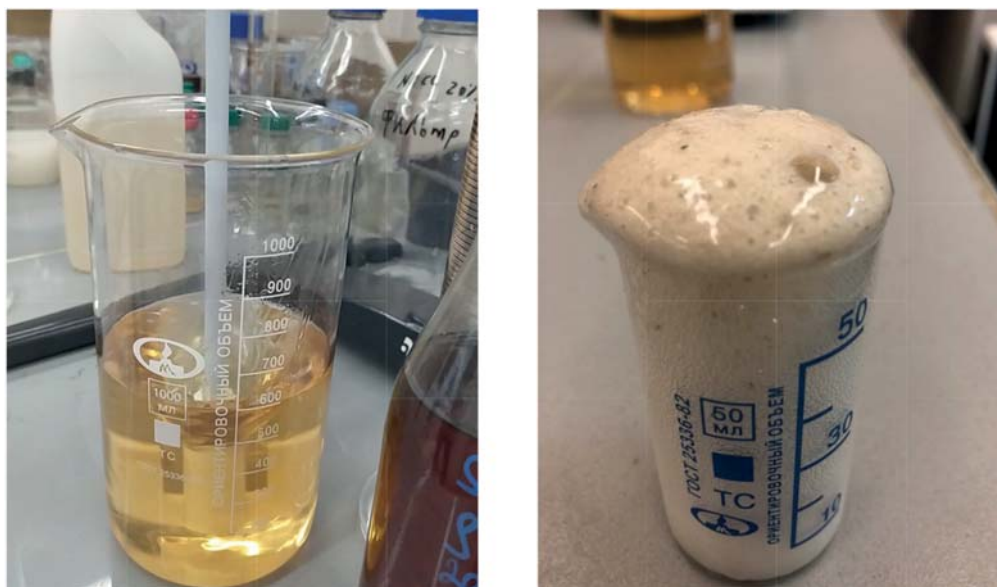
Рис. 2. Приготовление пенокислотного состава с добавлением ВУПАВ.
