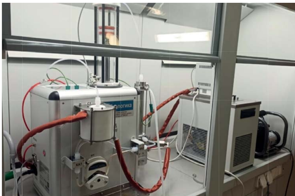
Рис. 3. Установка «ПИК ОСГ» для определения кинетики растворения карбонатных пород по темпу выделения \text{CO}_2 .
