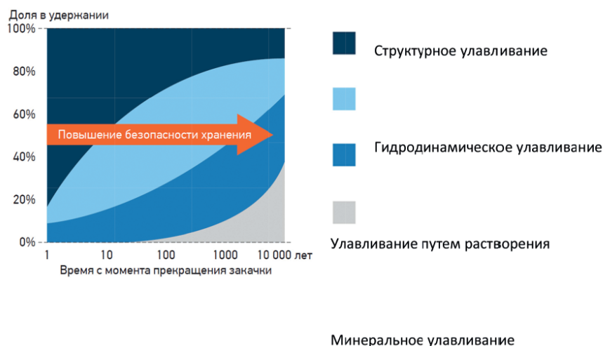
Рис. 1. Вклад механизмов удержания CO 2 в недрах в зависимости от времени [2].
