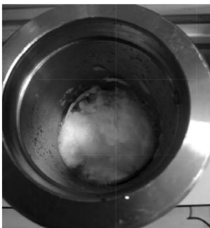
Рис. 1. Синтетические гидраты природного газа, полученные из дисперсного льда.
