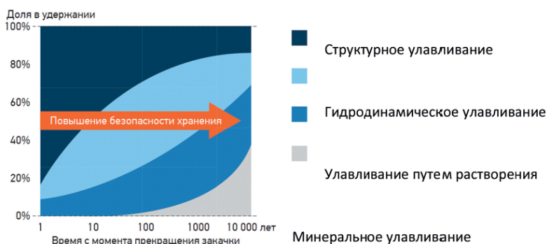
Рис. 6. Вклад механизмов удержания \text{CO}_2 в недрах в зависимости от времени [8].
